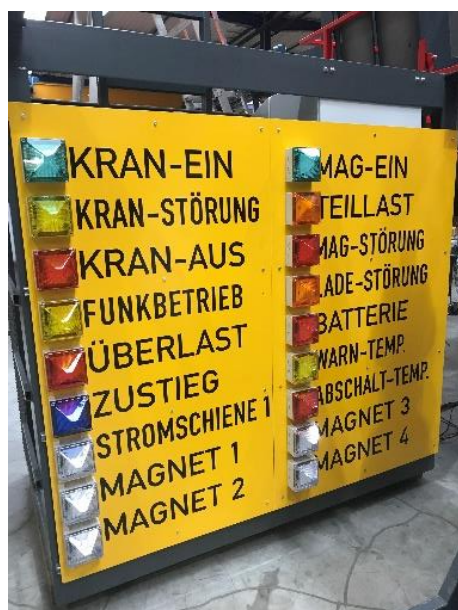
Bild 1: Anzeigetafel für Kranstati bei Voestalpine: Die Pfannenberg LED-Leuchten Quadro LED-HI sorgen für eine hohe Signalwirkung bei Höhen bis zu 13 Metern.
