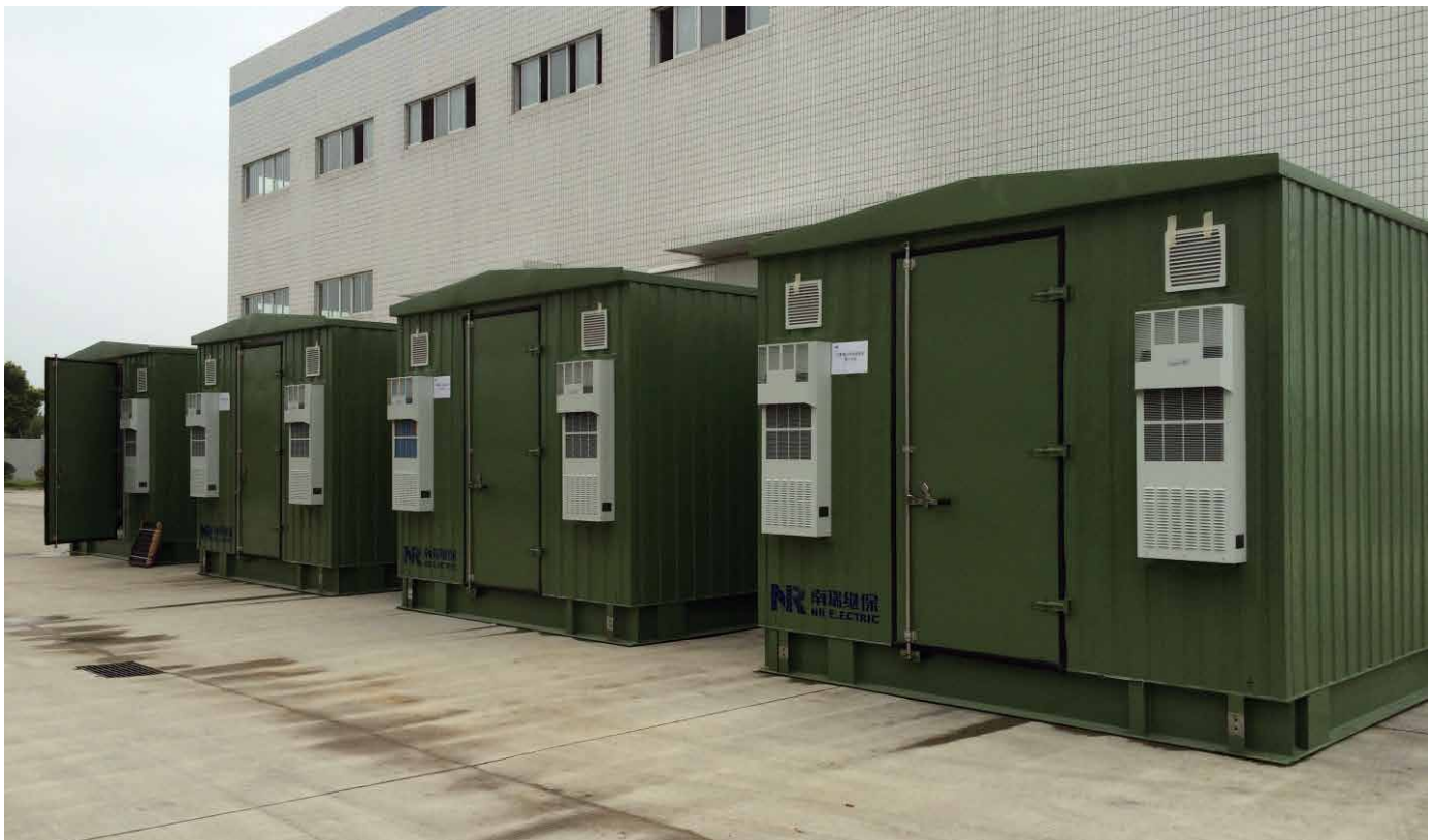
Container für den Einsatz in Höchstspannungs-Stromrichterstationen bei ihrer Endmontage bei NARI
