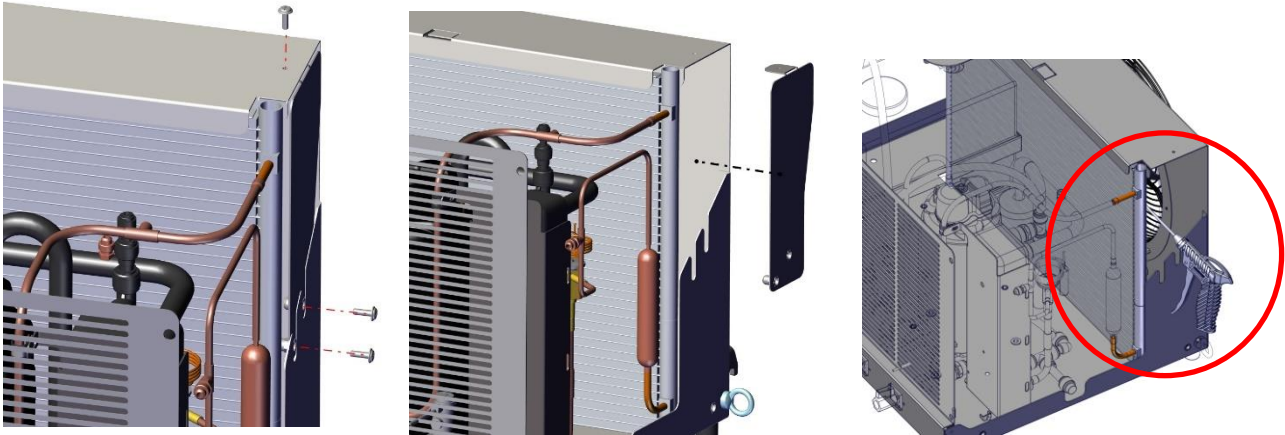
Figure 18 - Nettoyage du condenseur
