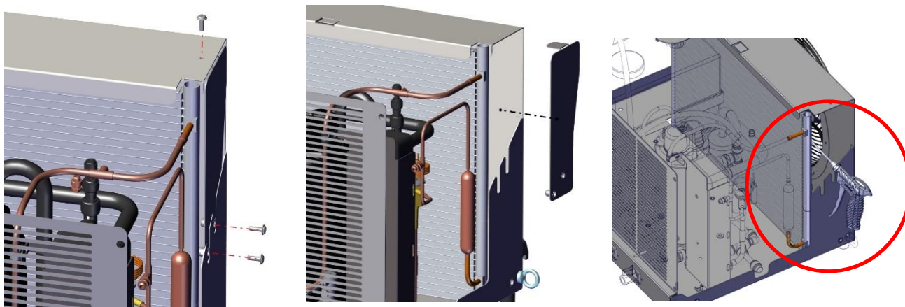
Figura 18 – Limpieza del condensador
