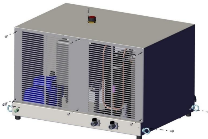
Figura 13 - tornillos que se deben quitar para tener acceso a la enfriadora
