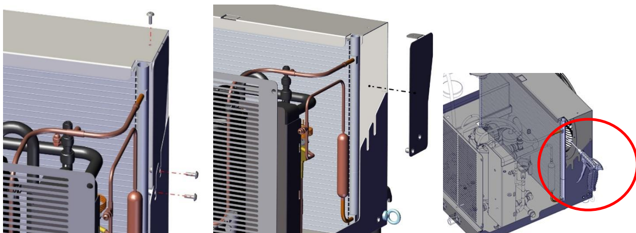
Figura 18 – pulizia del condensatore
